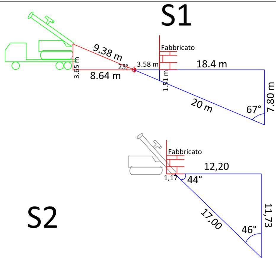
Schema geometrie di perforazione dei sondaggi
